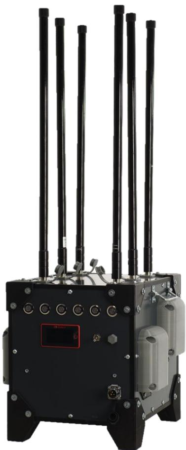
Средства радиоэлектронной борьбы (РЭБ), включающие в себя подавители беспилотных летательных аппаратов различных типов, являются ключевыми инструментами для контроля и обеспечения безопасности от нежелательного использования дронов. Эти устройства, разработанные для блокирования сигналов каналов управления и видео передачи операторов дронов, представляют собой важный элемент оборонительной стратегии.
