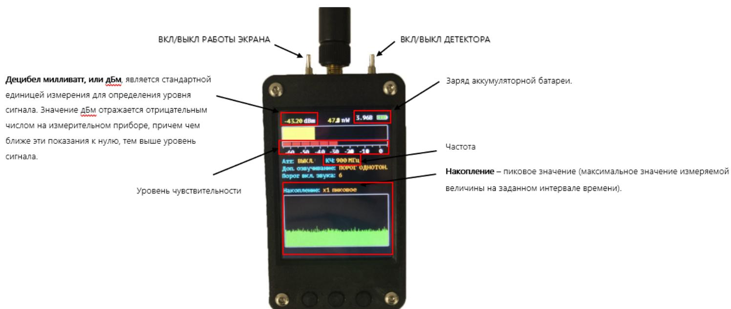
Короткое нажатие на **клавишу 1** переключает порог срабатывания дополнительной озвучки в пороговых режимах (порог отображается цифрой в соотв. пункте и в виде секторов красной линии под линией уровня сигнала), можно настраивать только когда включена сигнализация. Длинное нажатие на **клавишу 1** и ее удержание переключает по кругу таблицы частот коррекции.
